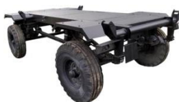
Шасси двухосное с тормозами, повышенной проходимости для АДД-4х2501В, АДПР-2х2501В с Д-242, АДДУ-4001ПР с Д-242 , длина 3,85м
