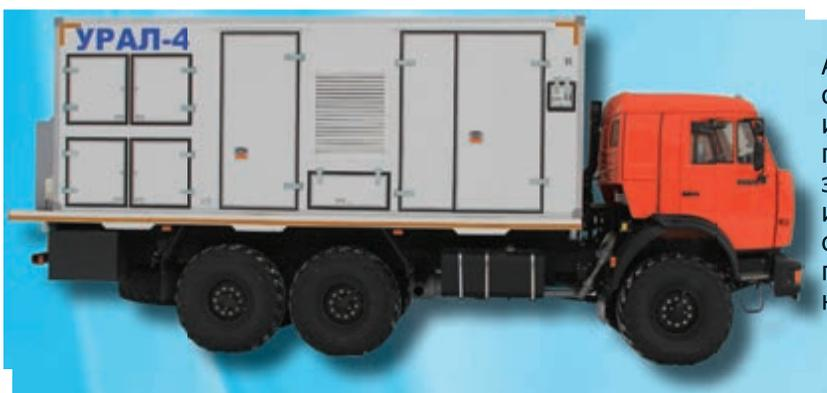
Агрегаты предназначены для проведения сварочных работ в полевых условиях с использованием одновременно до четырех постов электродуговой сварки, питания электроинструмента, других потребителей и освещения рабочих мест в темное время суток. Состав устанавливаемого оборудования подбирается индивидуально, под конкретные нужды Заказчика.
