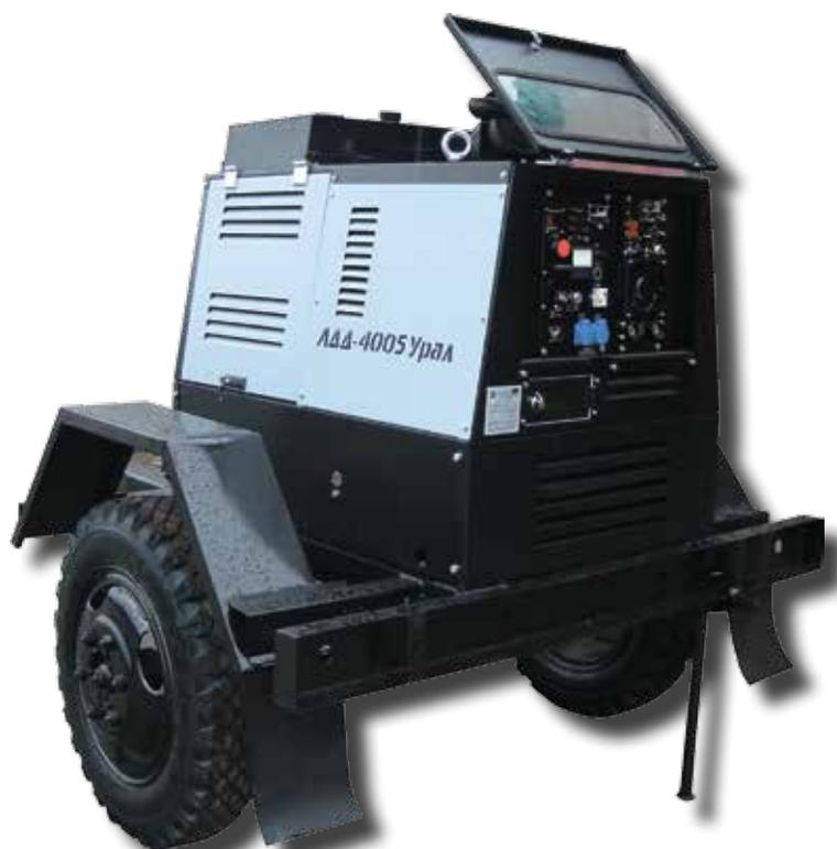
АДД-4005 Урал может комплектоваться чоппером ЧПР-315. Его подключение позволяет работать одновременно двумя постами без взаимного влияния. Номинальный ток каждого поста при таком подключении составит 225А.
