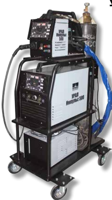
Комплектный полуавтомат инверторного типа Урал Импульс 500 предназначен для питания одного поста механизированной сварки плавящимся электродом в среде защитных газов (сплошной или порошковой проволокой) или ручной дуговой сварки.
