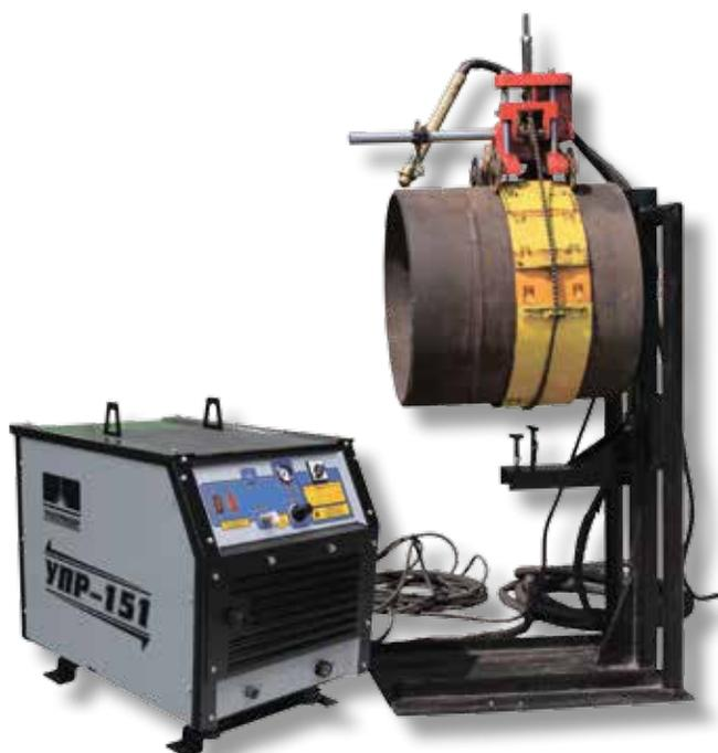
Предназначена для автоматической орбитальной плазменной резки труб и ручной резки любого металлопроката.
