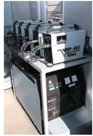
Утепленный сварочный модуль для перевозки в кузове автомобиля КАМАЗ. Имеет сварочный выпрямитель ВДМ-1201М, с пятью балластными реостатами РБ-306 или пятью частотными преобразователями ЧПР-315 Урал.
