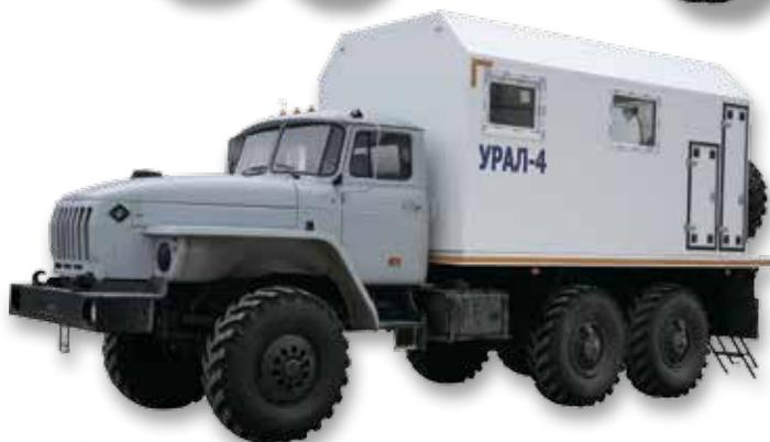
Кузов-фургон из цельных, полноформатных сэндвич-панелей толщиной 50-80мм, собранных по бескаркасной технологии. Наружняя отделка - плакированный металл, утеплитель - стиропен-50. Внутренняя отделка - плакированный металл.
